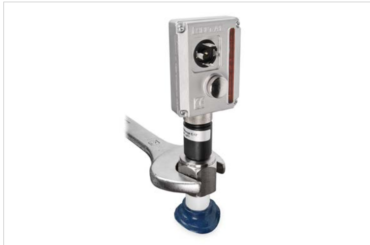
Monte el sensor en el recipiente. 80-150 Nm de par.
